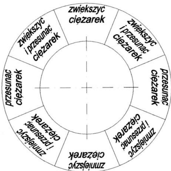
Rys 2.3 Schemat korekcji wielkości i miejsca mocowania ciężarków przy wyważeniu statycznym
