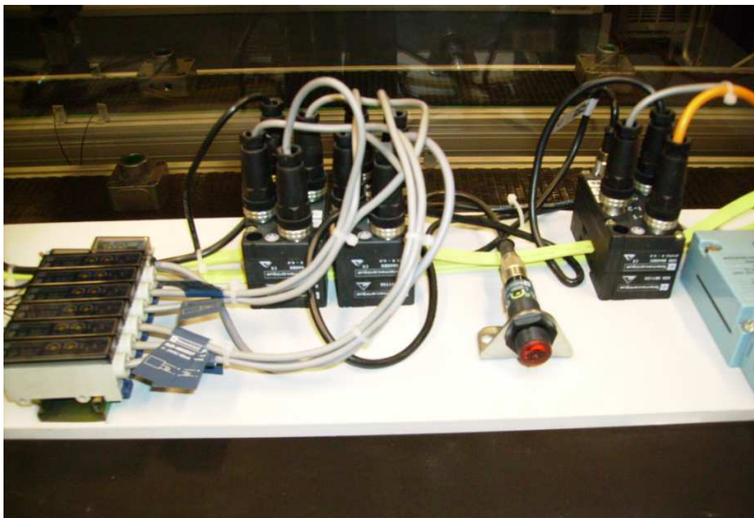
Rys. 2.3.6 Sposoby przyłączania urządzeń typu Slave: czujniki oraz aktywne bloki rozdzielaczy
