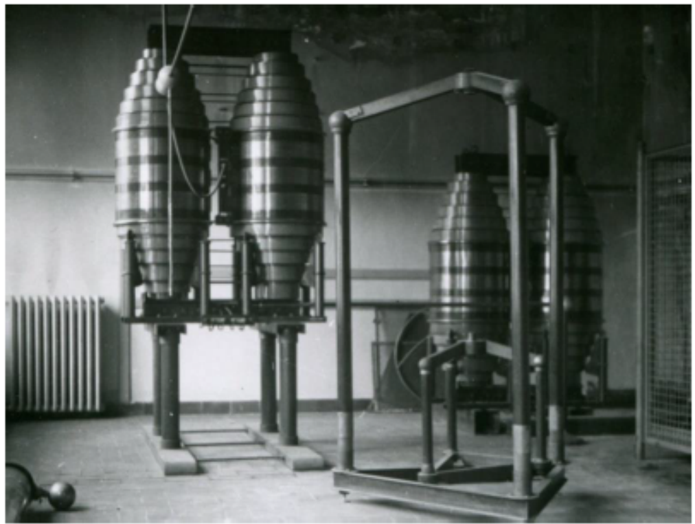
Układ kaskadowy transformatorów (300kV, 200kVA) w Laboratorium Wysokich Napięć z lat 30 XX wieku
