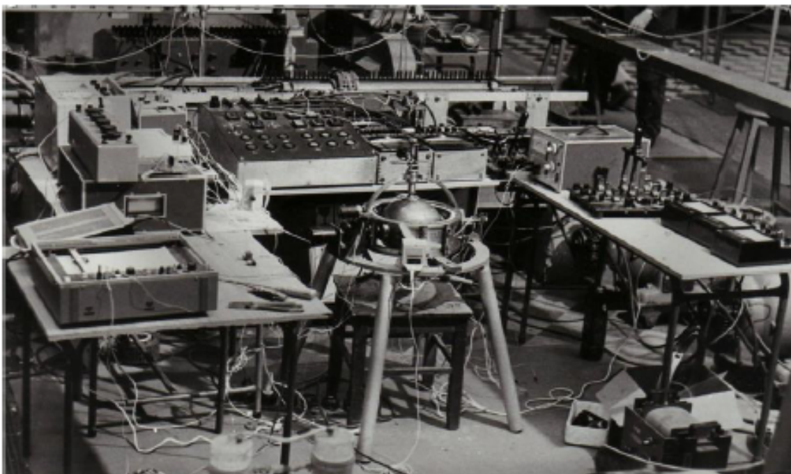
Stanowisko badawcze silnika o ruchu złożonym z wirnikiem sferycznym (w Laboratorium ZME 1985 rok)
