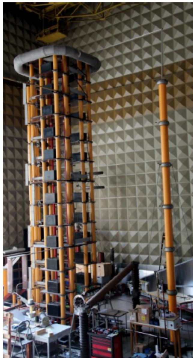
Układ kaskadowy transformatorów (300kV, 200kVA) w Laboratorium Wysokich Napięć z lat 30 XX wieku
