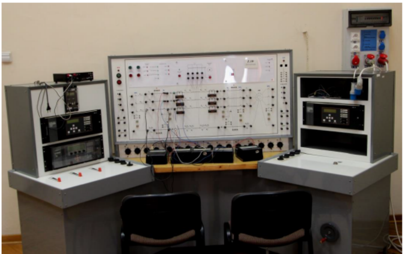
Stanowisko dydaktyczne do badania zwarć w systemach elektroenergetycznych z lat 80 XX wieku
