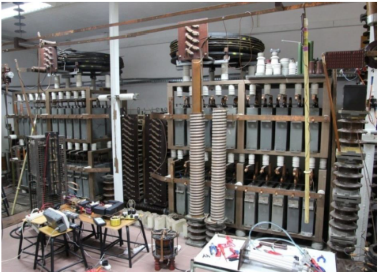
Układ syntetyczny do badań wyłączników energetycznych (z lat 70 – aktualnie modernizowany)
