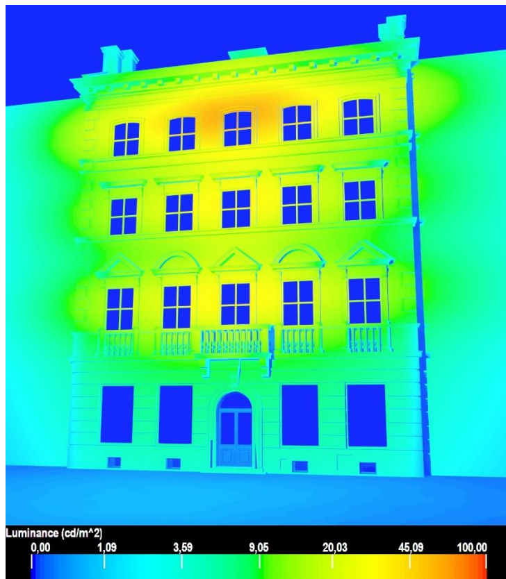
Rys. 4.17. Rozkład luminancji koncepcji zalewowej iluminacji kamieniczki na ul. Krakowskie Przedmieście 65 w Warszawie
