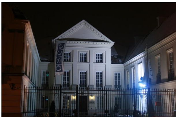
Rys. 1.9. Pałac Młodzieżowski w Warszawie jako przykład iluminacji obiektu przy zastosowaniu metody zalewowej
