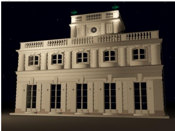
Rys. 5.24. Wizualizacja komputerowa iluminacji Białego Domku dla metody zalewowej po zmianie wycelowania i redukcji mocy
