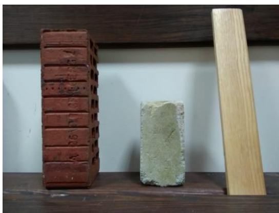
Rys. 3.10. Materiały, dla których został wyznaczony widmowy rozkład współczynnika odbicia; od lewej: czerwona cegła, biała cegła, drewno [117]
