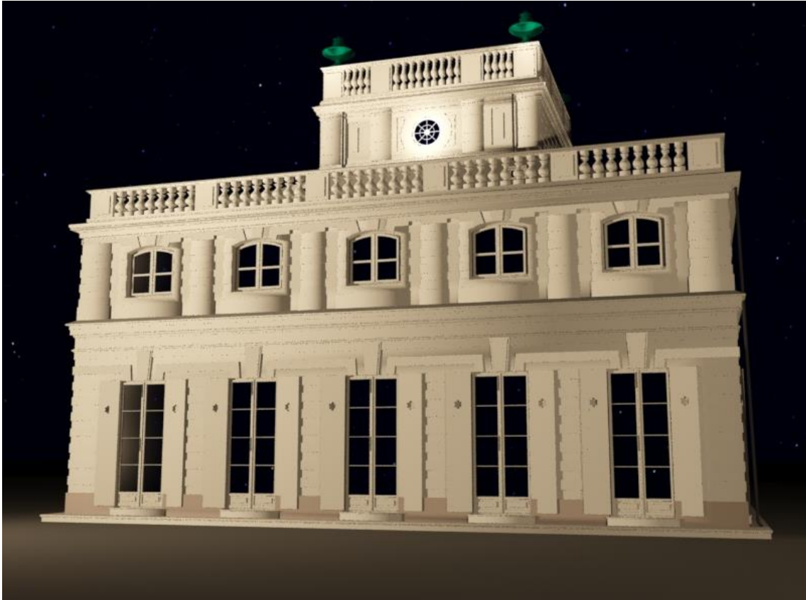
Rys. 5.1. Wizualizacja komputerowa iluminacji Białego Domku w Łazienkach Królewskich zrealizowanej metodą zalewową (kąt wycelowania 0^\circ )
