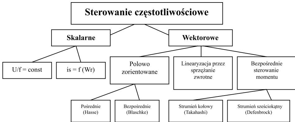
Rys. 3.1. Podział metod sterowania częstotliwościowego silników klatkowych
