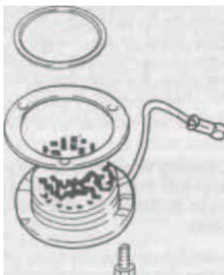
Rys 3.33 Typowa grzałka kolektora wlotowego.
