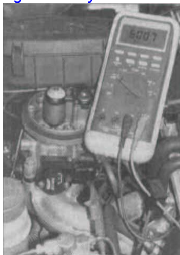
Rys 3.26 Pomiar sygnału wyjściowego czujnika położenia przepustnicy (potencjometru) za pomocą woltomierza.
