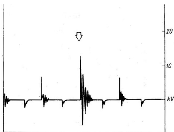
Rys 7.12 Po zdjęciu przewodu wysokiego napięcia
