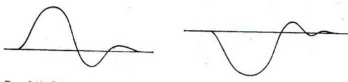
Rys 2.3 Oddziaływanie amortyzatorów na ruch drgający mas uresorowanych samochodu wywołanych pojedynczą przeszkodą
