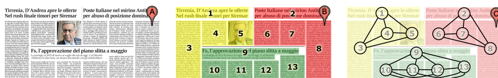
Rysunek 2.17: Przykład analizy logicznej z użyciem grafu: (a) strona oryginalna, (b) wydzielone bloki artykułów wraz z oznaczeniem numerycznym, (c) reprezentacja grafowa - każdy blok reprezentowany jest przez węzeł grafu i połączony jest z innymi węzłami przynależnymi do artykułu. Źródło:[6].
