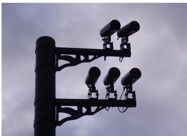
Rysunek 2.2: Zestaw kamer systemu Congestion Charge, umieszczony przy stacji Pimlico w Londynie. Źródło: http://en.wikipedia.org/wiki/London_congestion_charge
