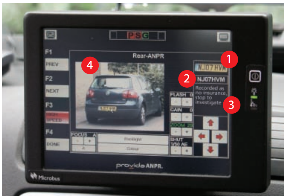
Rysunek 2.4: System ProVida ANPR w użyciu. 1) Obraz tablicy; 2) Rozpoznany numer; 3) Informacje operacyjne; 4) Podgląd obrazu. Źródło: http://www.petards.com/emergency_services/literature/provida_anpr.pdf
