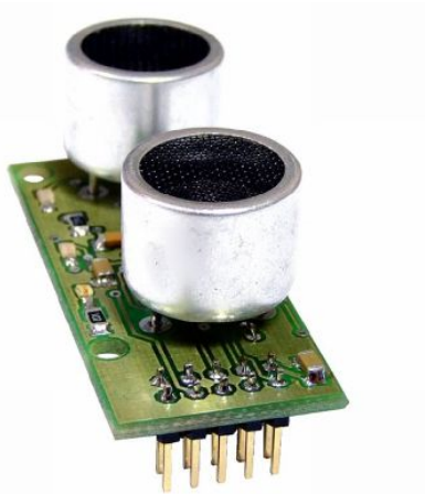
Rysunek 6.6: Sonarowy czujnik odległości MOBOT-USv2. Źródło: http://www.mobot.pl/download/images/sonar_Mobot-usv2_01_o.jpg
