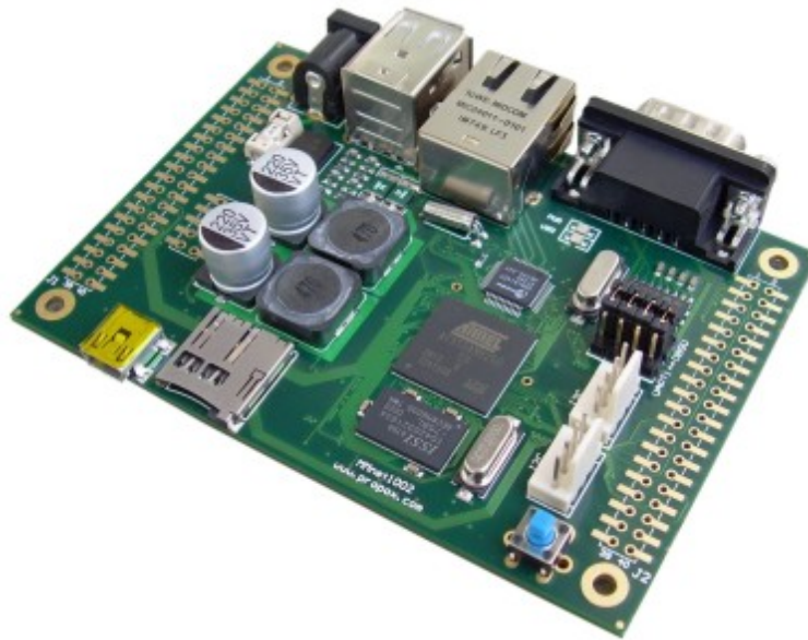
Rysunek 5.1: MMNet1002 - Minimoduł Ethernetowy z procesorem ARM9 400MHz oraz systemem Linux. Źródło: http://www.propox.com/products/t_232.html
