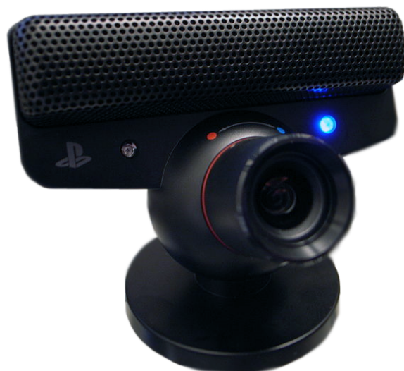
Rysunek 6.5: Urządzenie Playstation Eye; na górze widoczna grupa mikrofonów. Źródło: http://en.wikipedia.org/wiki/PlayStation_Eye
