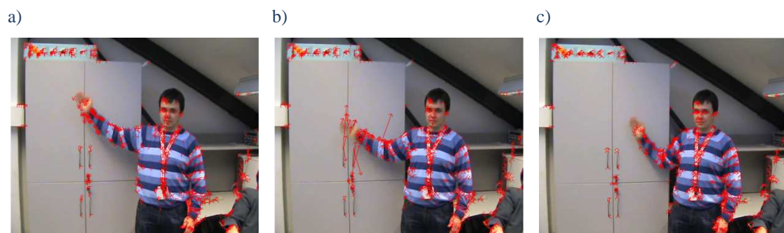
Rysunek 66. Przykład działania funkcji cvCalcOpticalFlowPyrLK z wykorzystaniem „cech dobrych do śledzenia”
