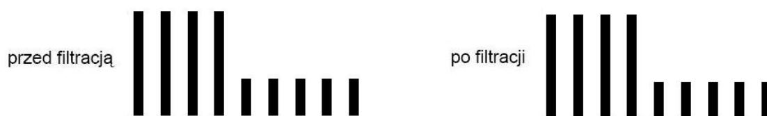
Rysunek 7. Wpływ filtru medianowego na brzegi obiektu.
