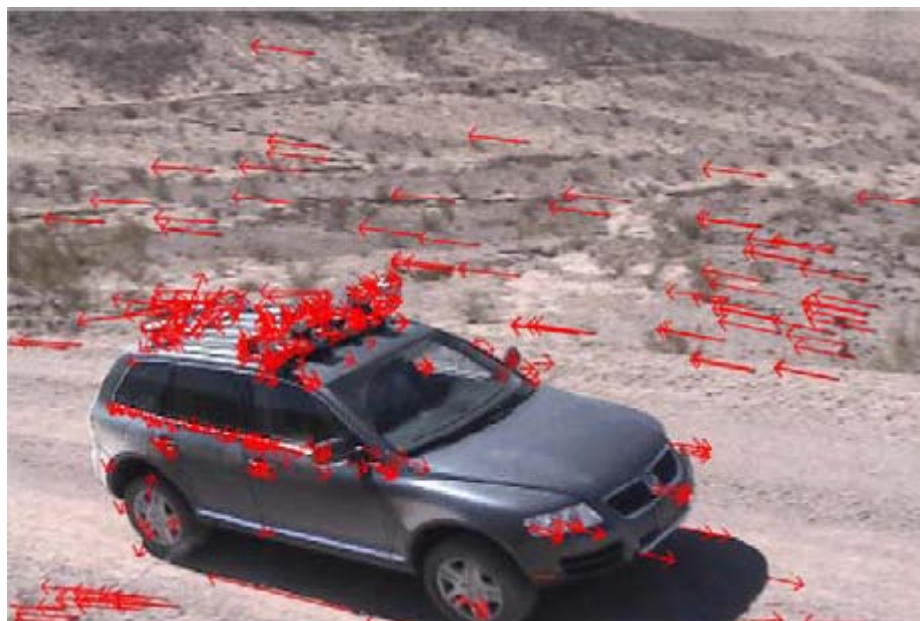
Rysunek 40. Obraz ilustruje przepływ optyczny wynikający z ruchu obiektu uzyskany przy pomocy funkcji cvCalcOpticalFlowPyrLK(...) .
