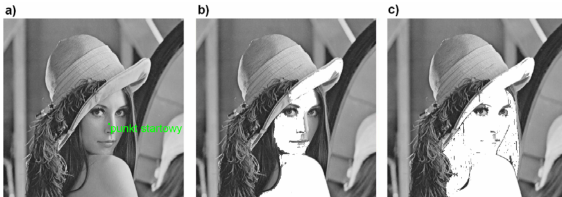
Rysunek 35. Obraz oryginalny z zaznaczonym punktem startowym (a), obraz po przekształceniach funkcją cvFloodFill (...) z tolerancją +/-4 (b), obraz po przekształceniach funkcją cvFloodFill (...) z tolerancją +/-7 (c).
