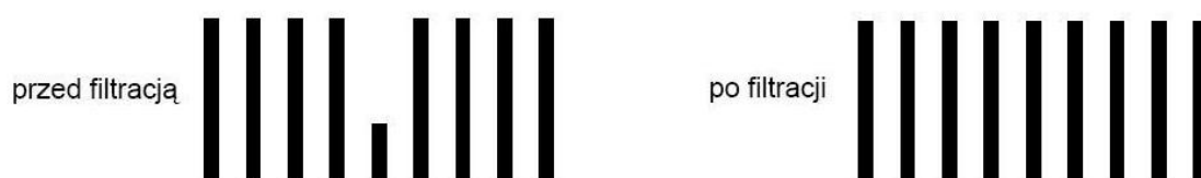
Rysunek 6. Usuwanie zakłóceń filtrem medianowym (wysokości zaznaczonych na rysunku słupków symbolizują wartości stopnia jasności przetwarzanych pikseli).
