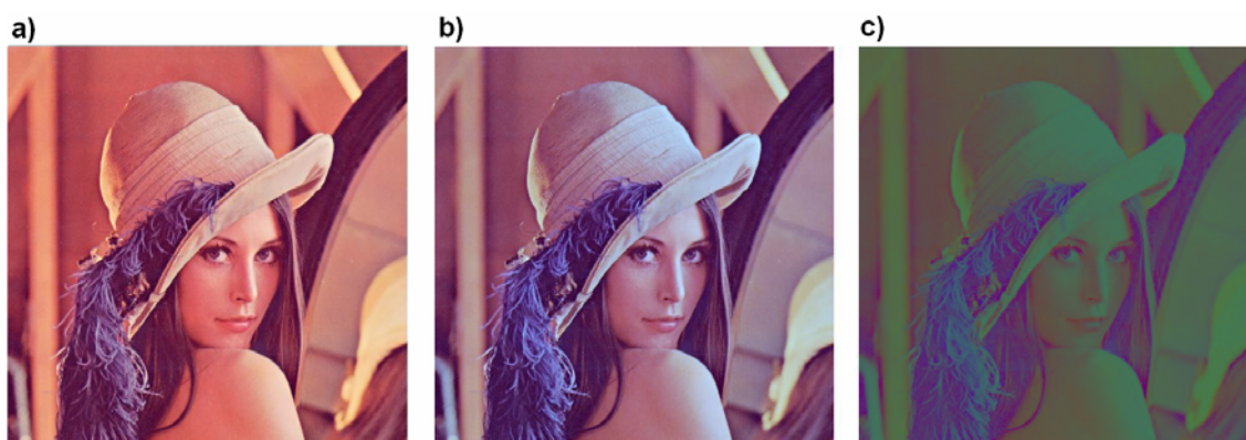
Rysunek 50. Obraz oryginalny (a), obraz po przetworzeniu funkcją lti::grayWorldNormalization (b), obraz po przetworzeniu funkcją lti::comprehensiveColourNormalization (c).
