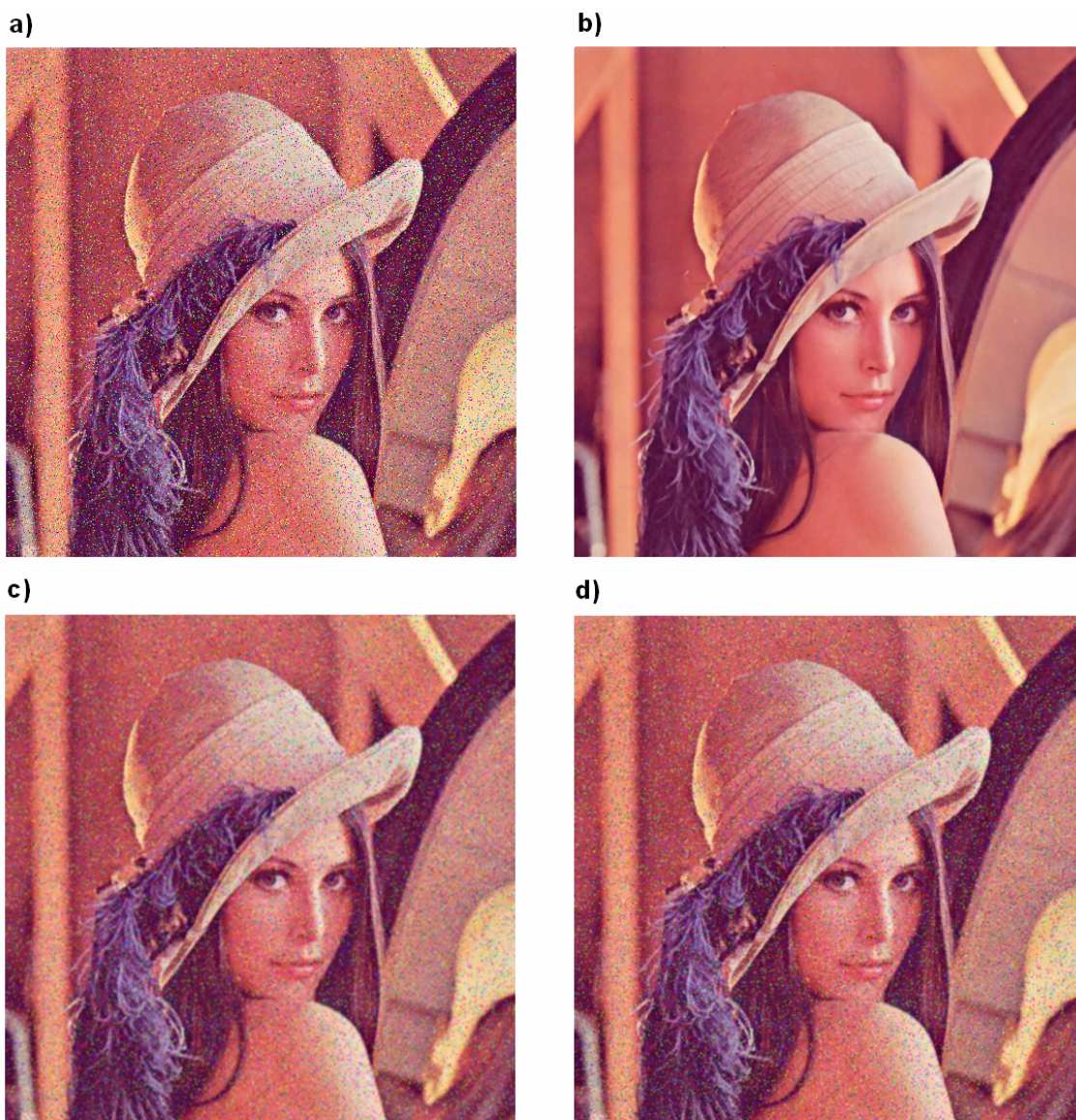
Rysunek 28. Obraz oryginalny z szumem Salt and Pepper (a), obraz po filtracji medianowej 3x3 (b), obraz po filtracji rozmywającej – blur (c), obraz po filtracji filtrem gaussa (d).
