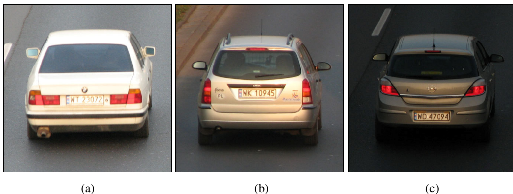
Rysunek 28. Zdjęcia zarejestrowane w kierunku padania promieni słonecznych: (a) ustawienie automatyczne; (b) korekcja -1EV; (c) korekcja -2EV.
