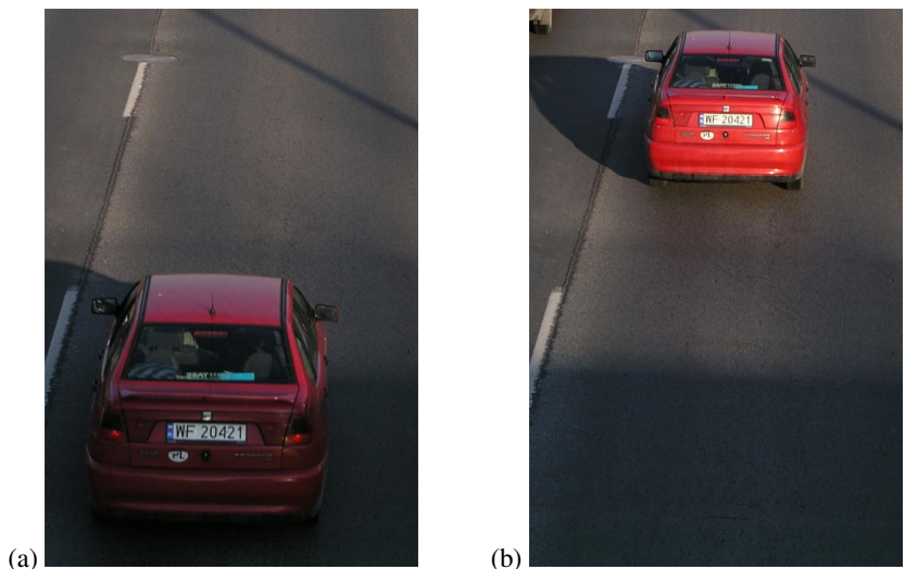
Rysunek 32. Problem cienia: (a) pojazd w obszarze zaciemnionym; (b) pojazd w obszarze niezaciemnionym.
