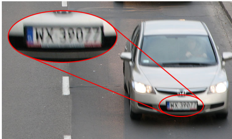
Rysunek 29. Rezultat długiego czasu naświetlania podczas rejestracji szybko poruszających się pojazdów. Czas naświetlania = 1/60s. W tym czasie pojazd jadący 50km/h przejeżdża ok. 23cm.
