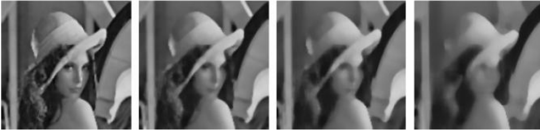
Rysunek 14: Efekt działania filtru medianowego dla masek kolejno 3x3, 5x5, 7x7, 9x9 [33].
