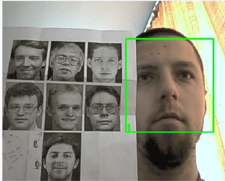
Rysunek 46: Obraz z detekcją skóry. Twarze znajdujące się na zdjęciach w odcieniu szarości nie zostały wykryte.
