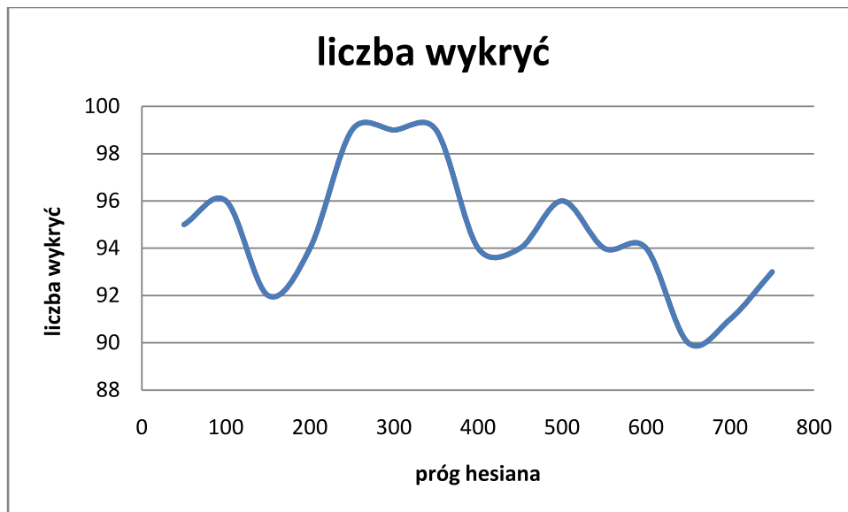
Rys.6.2.8 Liczba wykryć klocka na 100 zdjęć w zależności od progu hesjanowego
