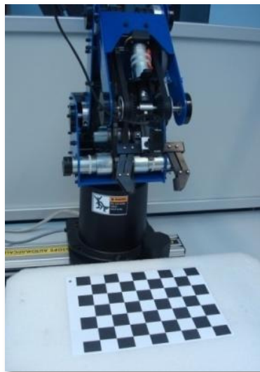
Rys. 3.1.2. Wyznaczenie macierzy transformacji {}^K T_S
