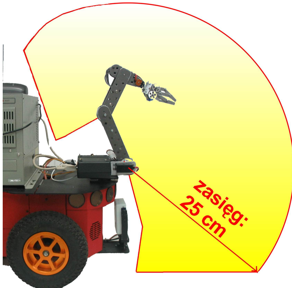
Rys.16 Zasięg manipulatora z pokładu pojazdu Pioneer 3-DX
