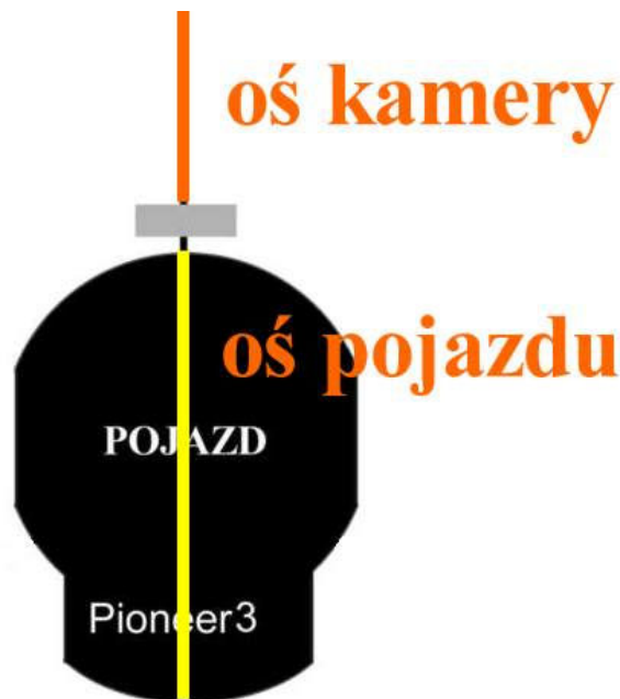
Rys.5 Osie kamery i pojazdu
