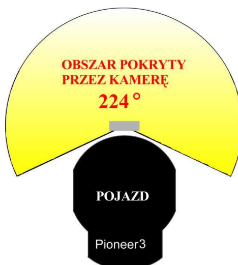
Rys.8 Pole widzenia kamery w poziomie
