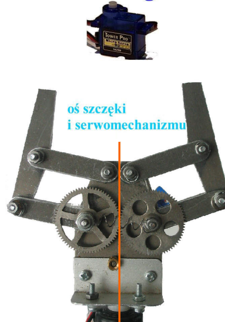
Rys.12 Chwytnik - prototyp i wersja ostateczna
