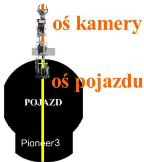
Rys.13 Ustawienie ramienia względem pojazdu i kamery
