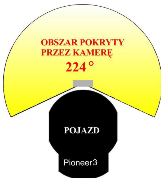
Rys.45 Optyczne pokrycie obszaru przez kamerę w funkcji „PrzeszukajOtoczenie”
