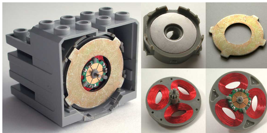
Rys. 2.6 Cewki silnika nr 43362
