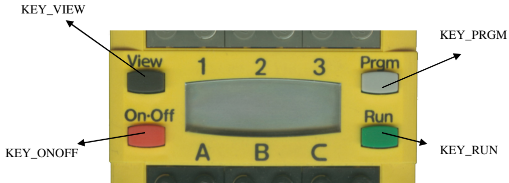
Rys. 5.3 Kody przycisków (dkey.h)
