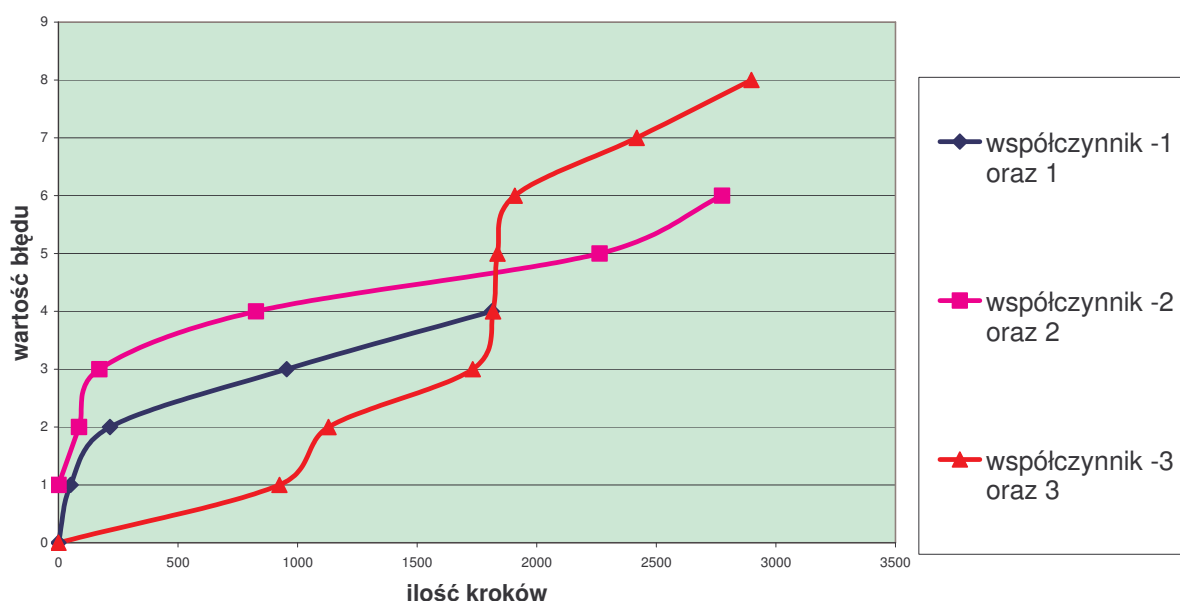
Rys. 34 Rysunek przedstawiający przykładowe zależności pomiędzy czasem symulacji i ilością błędów dla pojawiających się zakłóceń niesystematycznych
