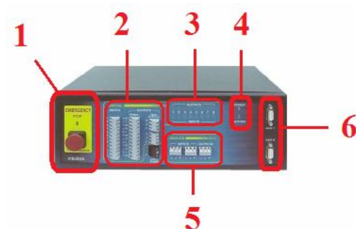
Rysunek 3: Panel przedni sterownika robota. 1 – wyłącznik awaryjny pozwalający zatrzymać robota w każdym momencie, 2 – zaciski wejść i wyjść cyfrowych, 3 – lampki kontrolne sygnalizujące stan wyjść cyfrowych, 4 – lampka sygnalizująca obecność zasilania i zezwolenie na ruch, 5 – zaciski wejść analogowych, 6 – złącza umożliwiające podłączenie zewnętrznych osi. Źródło: własne.
