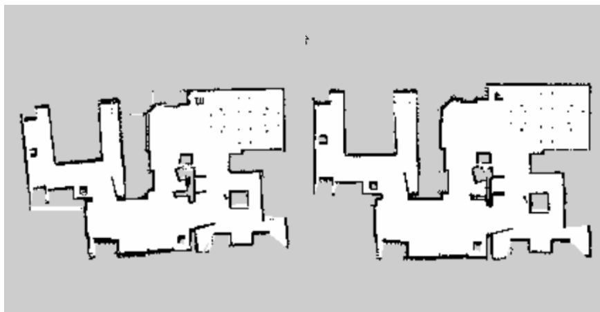
Rys. 5.3. Mapa utworzona podczas pierwszej próby (z lewej) i mapa prawidłowa powstała po zmianach w konfiguracji pakietu gmapping (z prawej) [źródło: własne]
