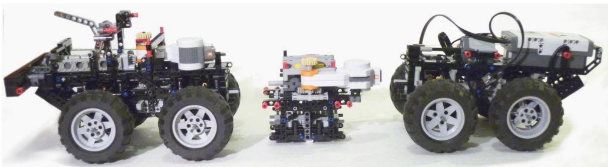
Rysunek 18. Rozczepione podwozie pojazdu pozwalające na serwis.
