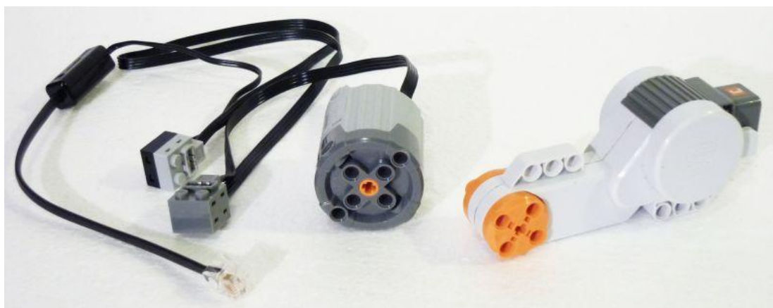
Rysunek 7. Po lewej silnik Power Functions XL wraz z przejściówkami, po prawej silnik NXT.
