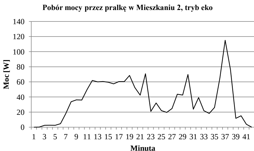
Rys. 4.4. Fragment przebiegu poboru mocy przez pralkę w Mieszkaniu 2, tryb eko. Pomiary własne.
